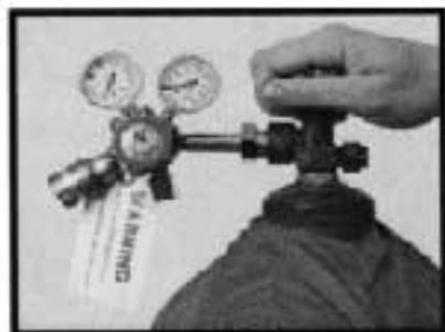
2. 1 1/8レンチを使って、レギュレーターを取付けて下さい。
